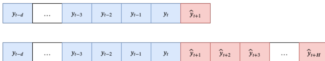
Figura 2.1: Representación de pronóstico a un paso y múltiples pasos en el tiempo
